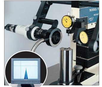
刃先をCCDカメラで拡大し、モニターで確認することができます。非接触方式のため小径工具でも折れる心配がありません。工場出荷時のオプションです。
