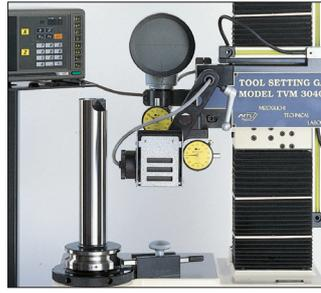
プロジェクタによる投影により刃先形状を拡大視できます。特に段付き工具のプリセットに便利です。
