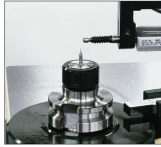
低圧測定リニアゲージを使用し、刃径φ0.5mmのエンドミルの径測定、振れ測定が可能です。工場出荷時のオプションです。
