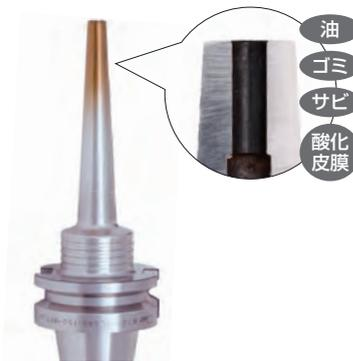
ゴミ・油・サビ・酸化皮膜が付着した状態で焼ばめ作業を繰り返行くと・・・
