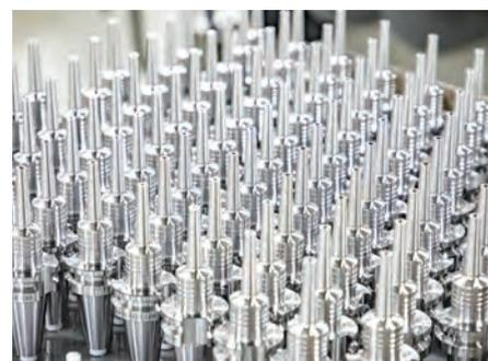
材料調達 ▶ 旋削 ▶ フライス ▶ 研削 ▶ 組立 ▶ 検査
